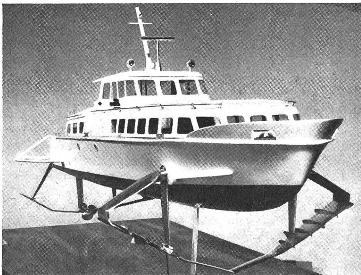
Modell eines Supramar-Tragflügelbootes PT 20, wie es im Verkehrshaus der Schweiz in Luzern und im Deutschen Museum in München zu sehen ist.
