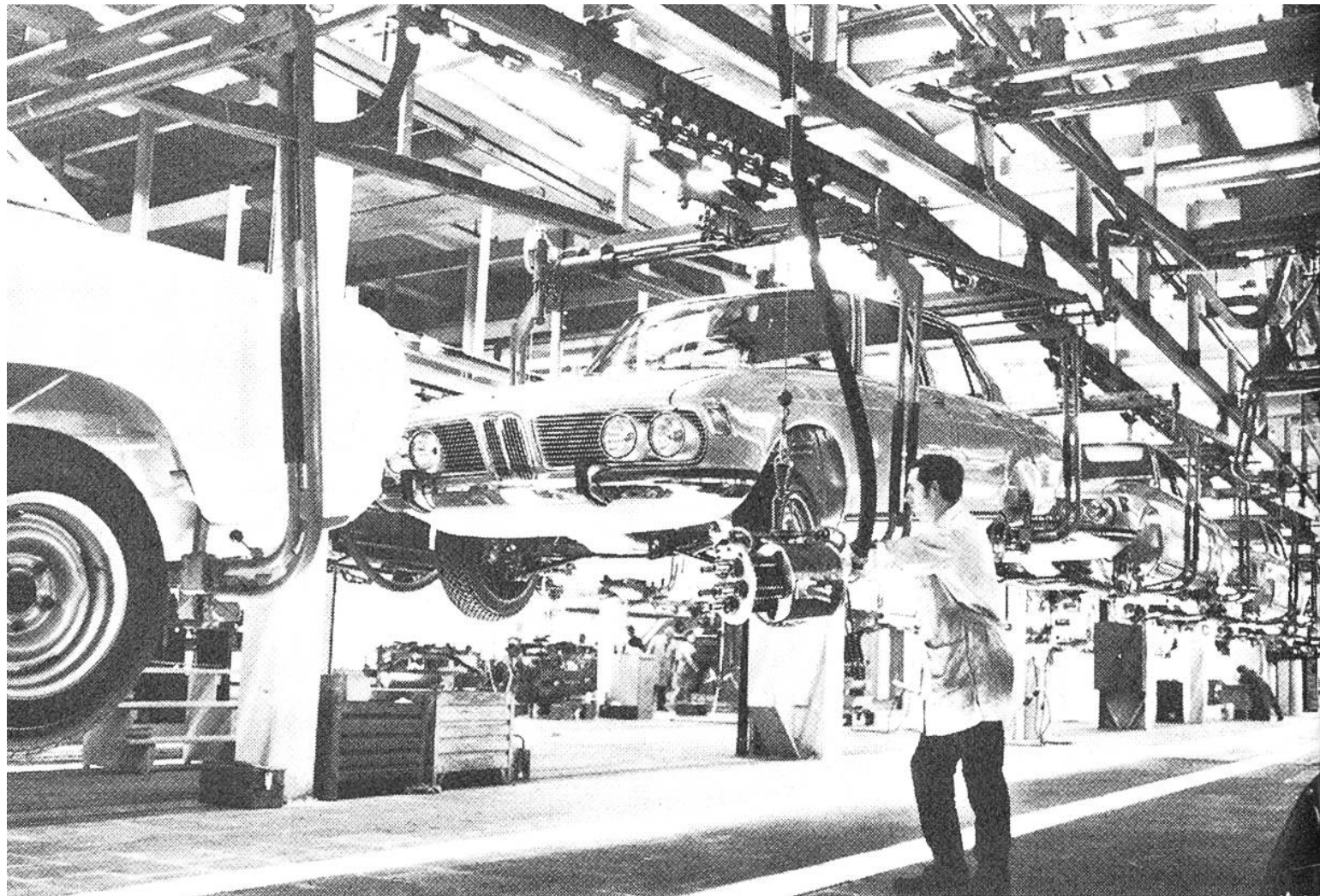
Am Ende des «Fertigmacher»-Bandes: Radmontage mit Schraubenvorrichtung, die alle fünf Schrauben gleichzeitig gleichmässig anzieht.
