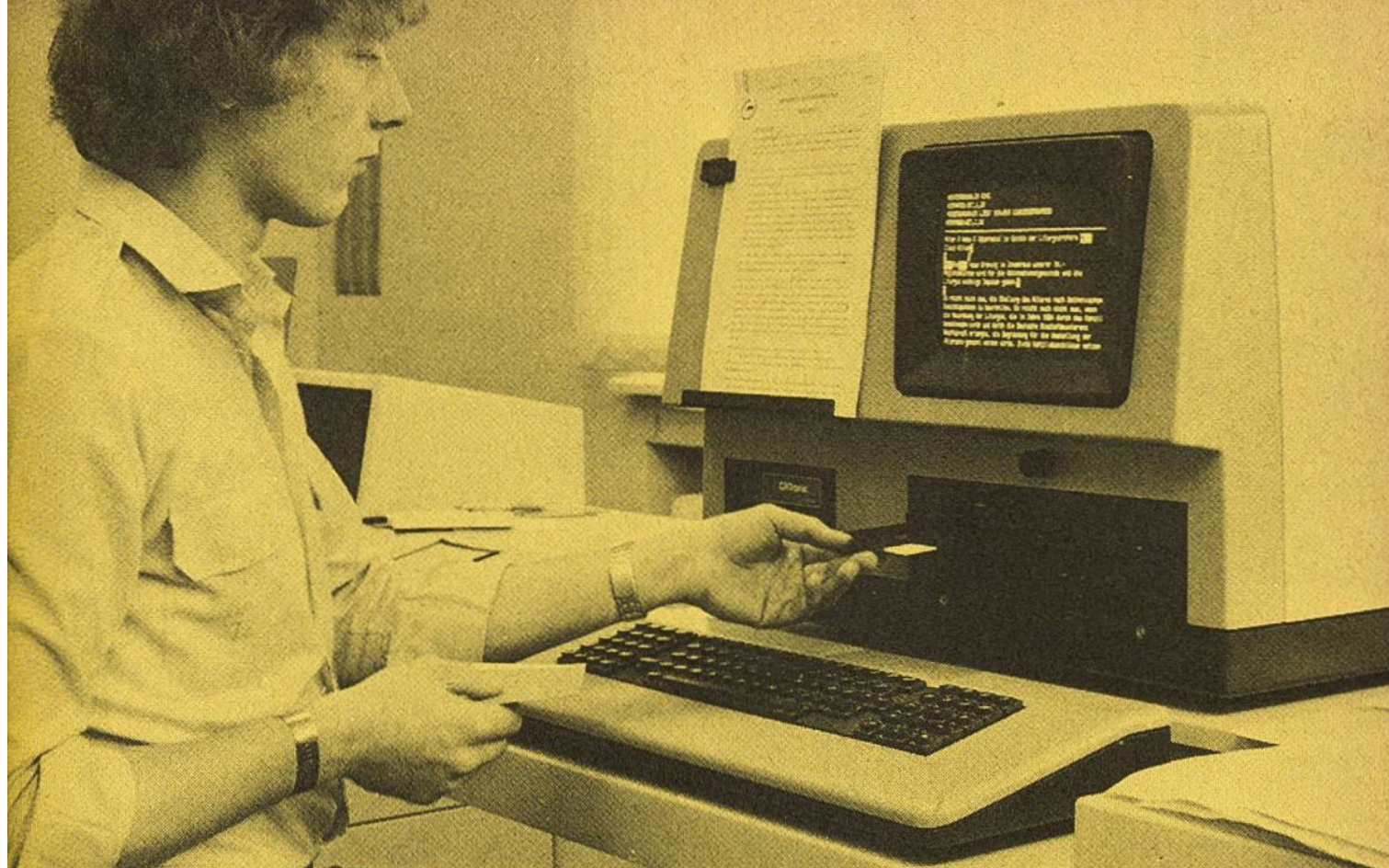
Der Schriftsetzer an einem seiner modernen Arbeitsplätze: Den Text tippt er ab seinem Manuskript in die Fotosetzmaschine auf eine Diskette. Am Bildschirm erscheint der getippte Text zur Kontrolle und allfälligen Korrektur.
