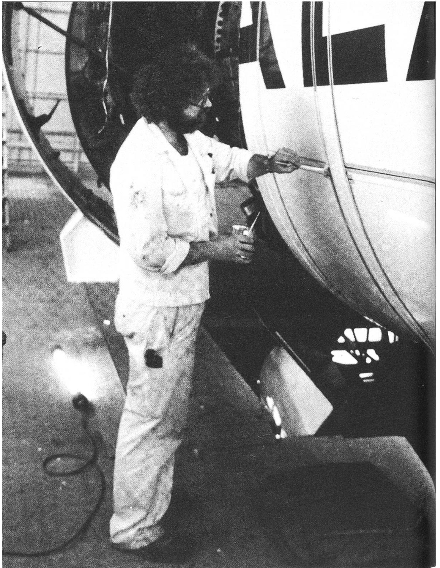
Fast fünf Stockwerke über dem Boden bessert der Maler Farbschäden am Hecktriebwerk aus, das im Leitwerk montiert ist.
