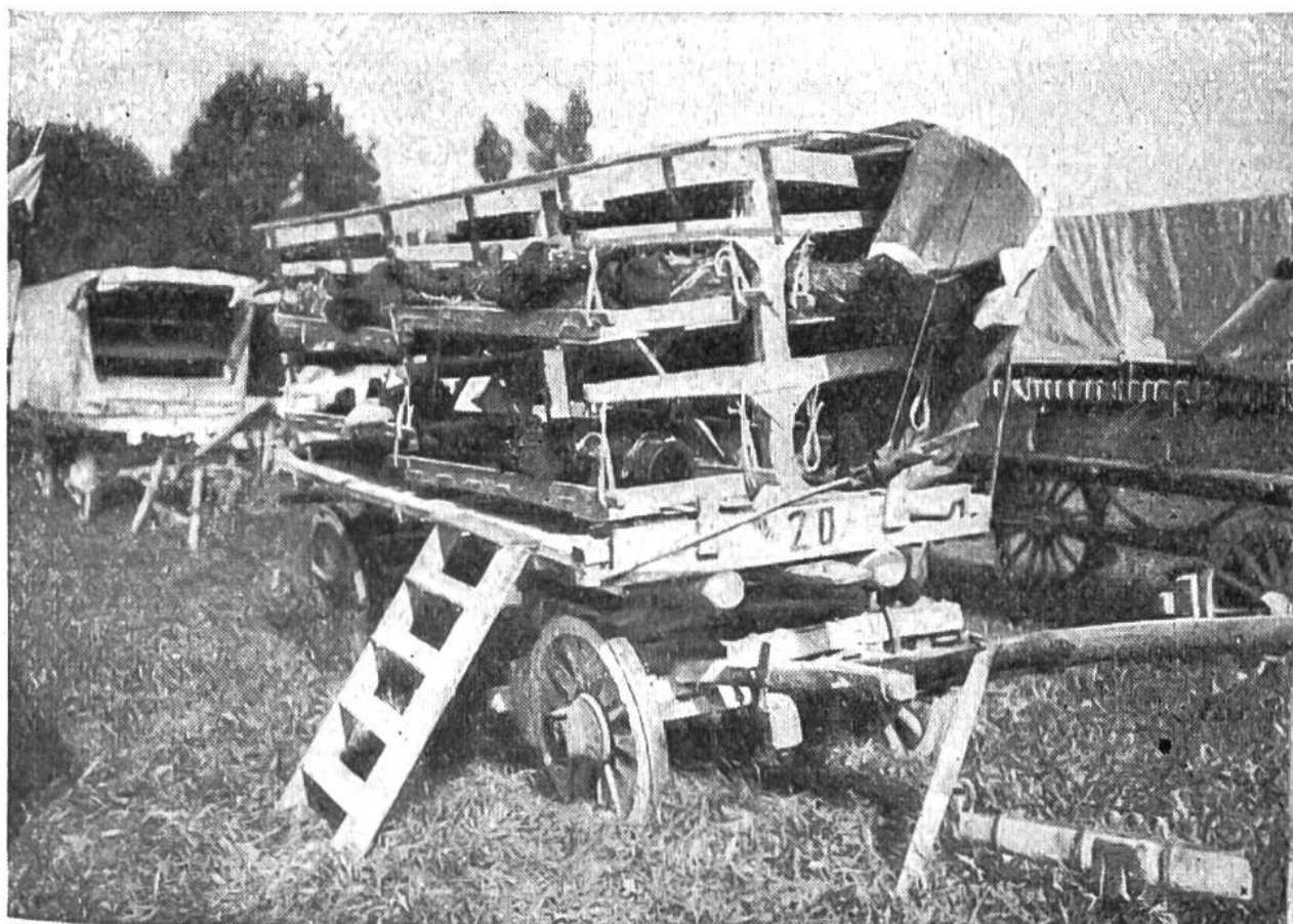
Von der Sanität requirierter Brückenwagen, zum Transport acht Verwundeter hergerichtet.
