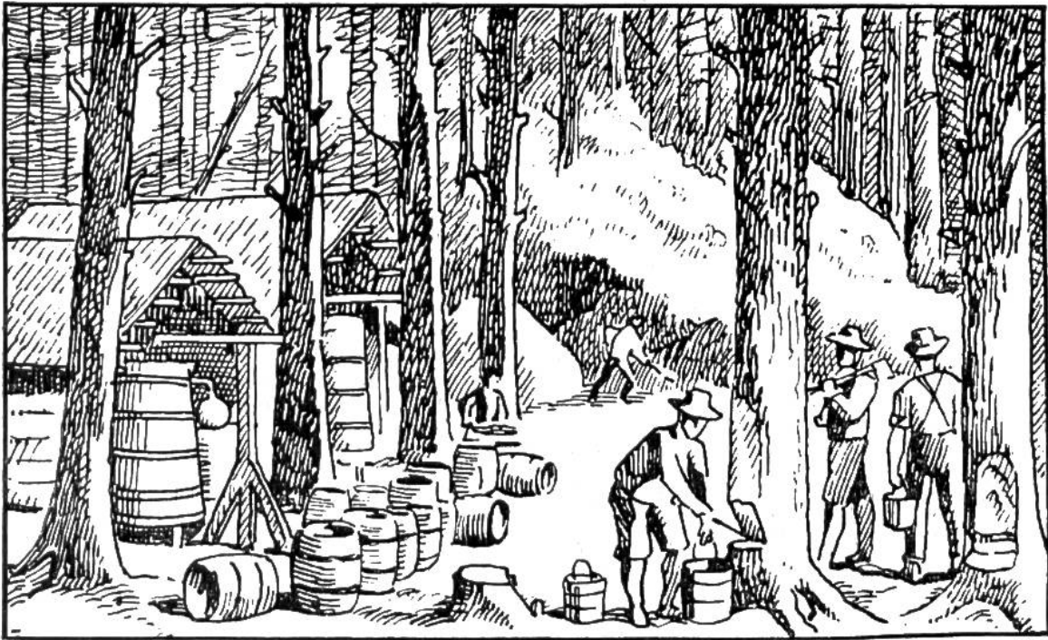
Pechsiederei im nordamerikanischen Urwalde. Im Vordergrund: Sammeln des Harzes. Hinten: Kohlenmeiler zur Gewinnung des Holzteers.
