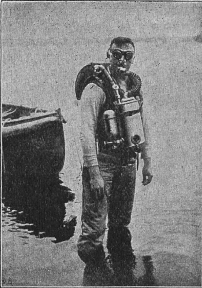
Kleiner Taucherapparat zur Rettung Ertrinkender. Er kann im Notfall in 1\frac{1}{2} Minuten betriebsfertig angezogen werden.
