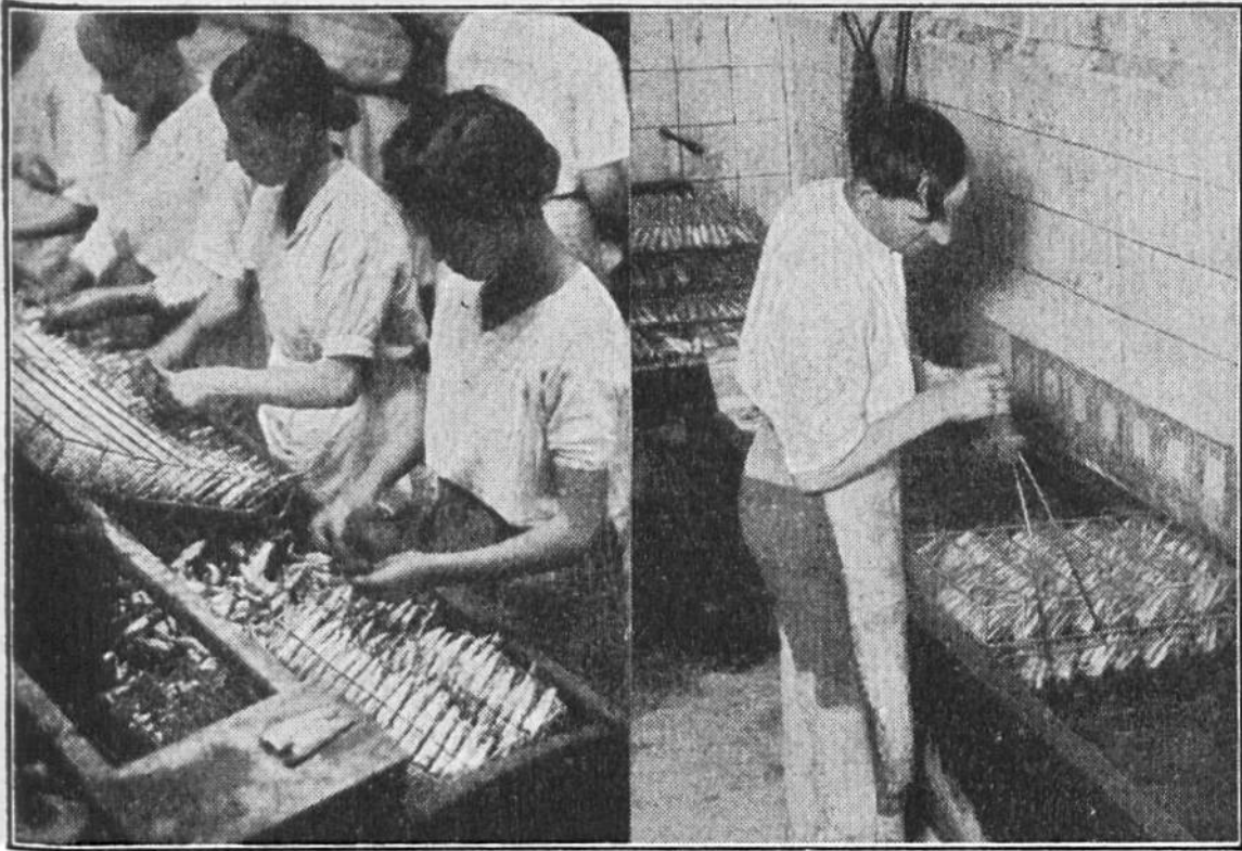
Die ausgenommenen und entköpften Sardinen werden in Drahtkörbe sortiert und dann in siedendes Öl getaucht.
