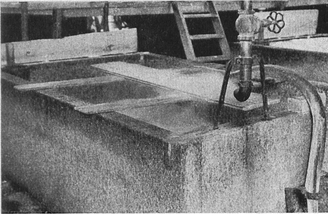
Die gereinigte und entfettete Baumwolle kommt zum Bleichen mittels Säuren in grosse Granittröge.
