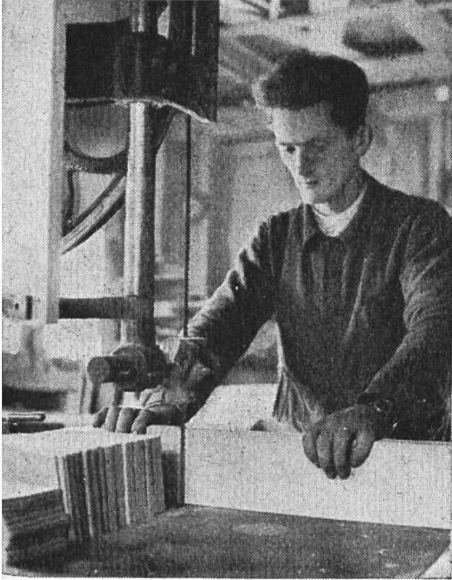
Dünne Sperrholzplatten werden in die für Böden und Deckel benötigten Stücke zersägt.
