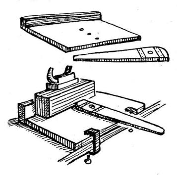
einem Brettchen verfertigen wir uns einen Klemmer mit einem Loch für eine Schraube. Damit der Klemmer beim Spannen nicht springt, schneiden wir aus einer Konservenbüchse Streifen, die wir auf den Klemmer aufnageln (Fig. 2). Mit einer oder besser zwei Klammern für Laubsägebrettchen wird der Spannstock am Tisch befestigt.
