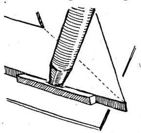
Winkel aus Holz gezimmert ist, diesen anschneidet. Ist ein Eisenwinkel vorhanden, trägt das Messer den Schaden in Form von Scharten davon. Diesem Missgeschick hilft man ab, indem man mit dem Messer durch die Längsseite eines Zündhölzchens ohne Kopf sticht. Dadurch wird auch manche Schnittwunde verhütet.
