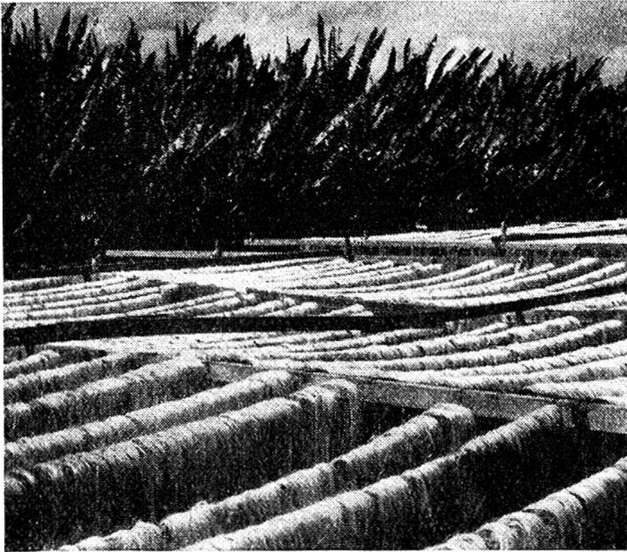
Auf Holzgestellen trocknen die Sisalfasern in der heißen Sonne.
