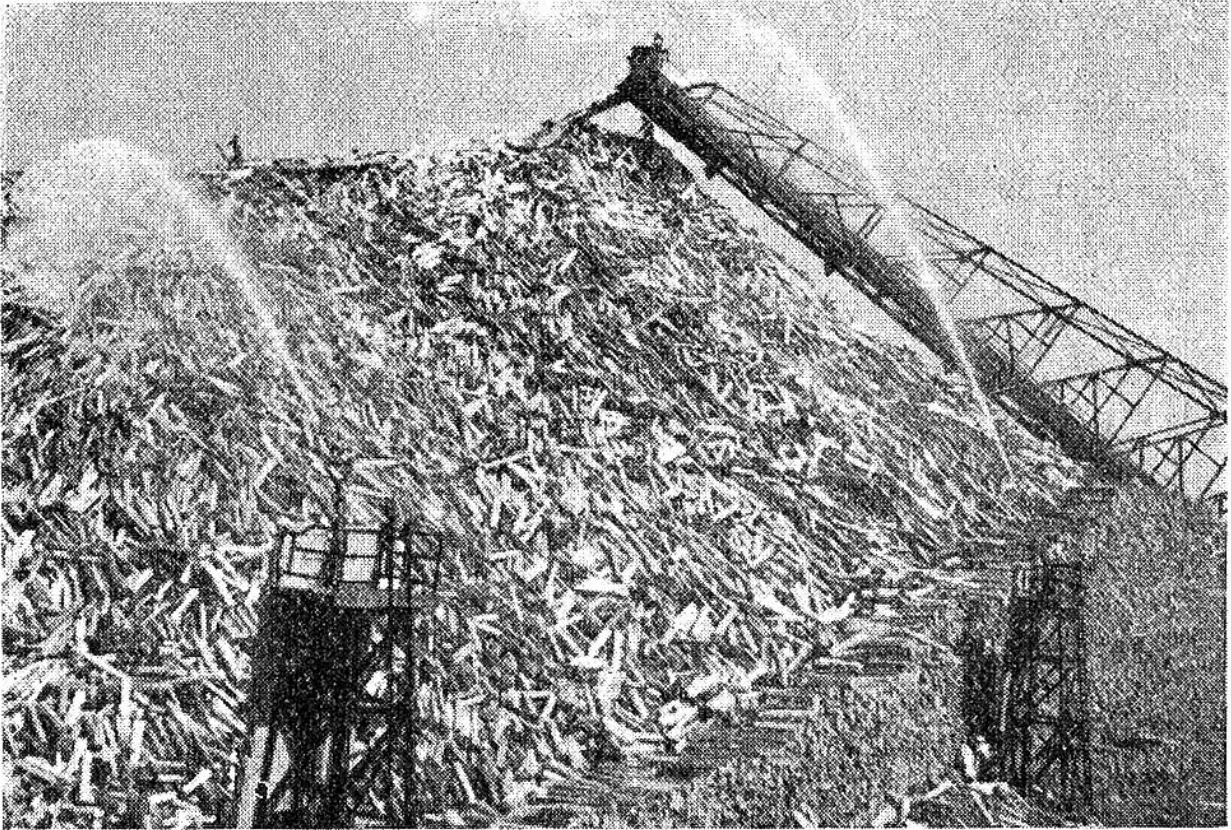
Hydranten schützen ein grosses Papierholzlager vor Selbstentzündung.
