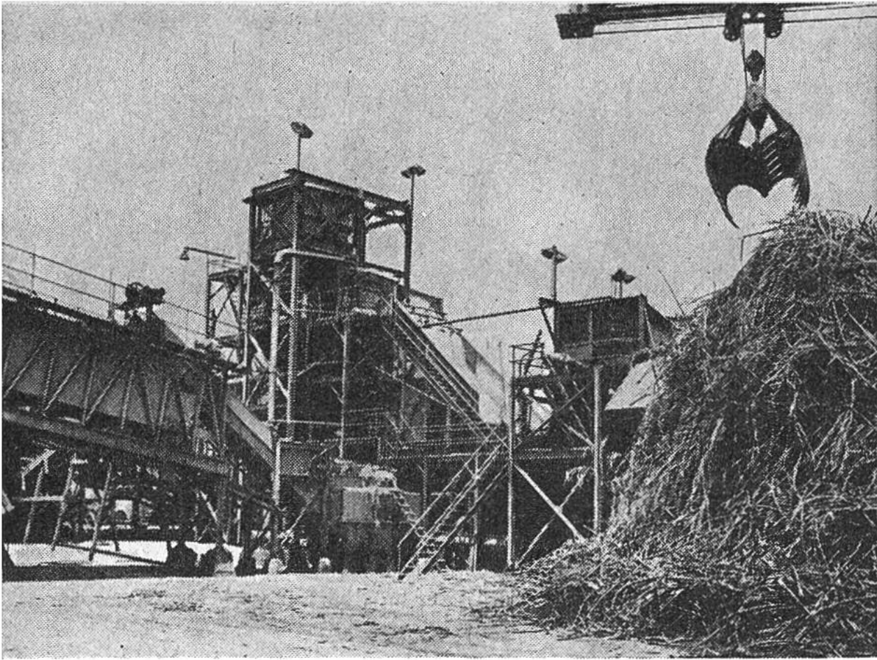
Die geernteten Zuckerrohrstengel werden im Fabrikhof zu Haufen geschichtet. Am Kran befindet sich ein Greifer, der die Stengel zur Wäscherei und zu den Pressanlagen befördert.
