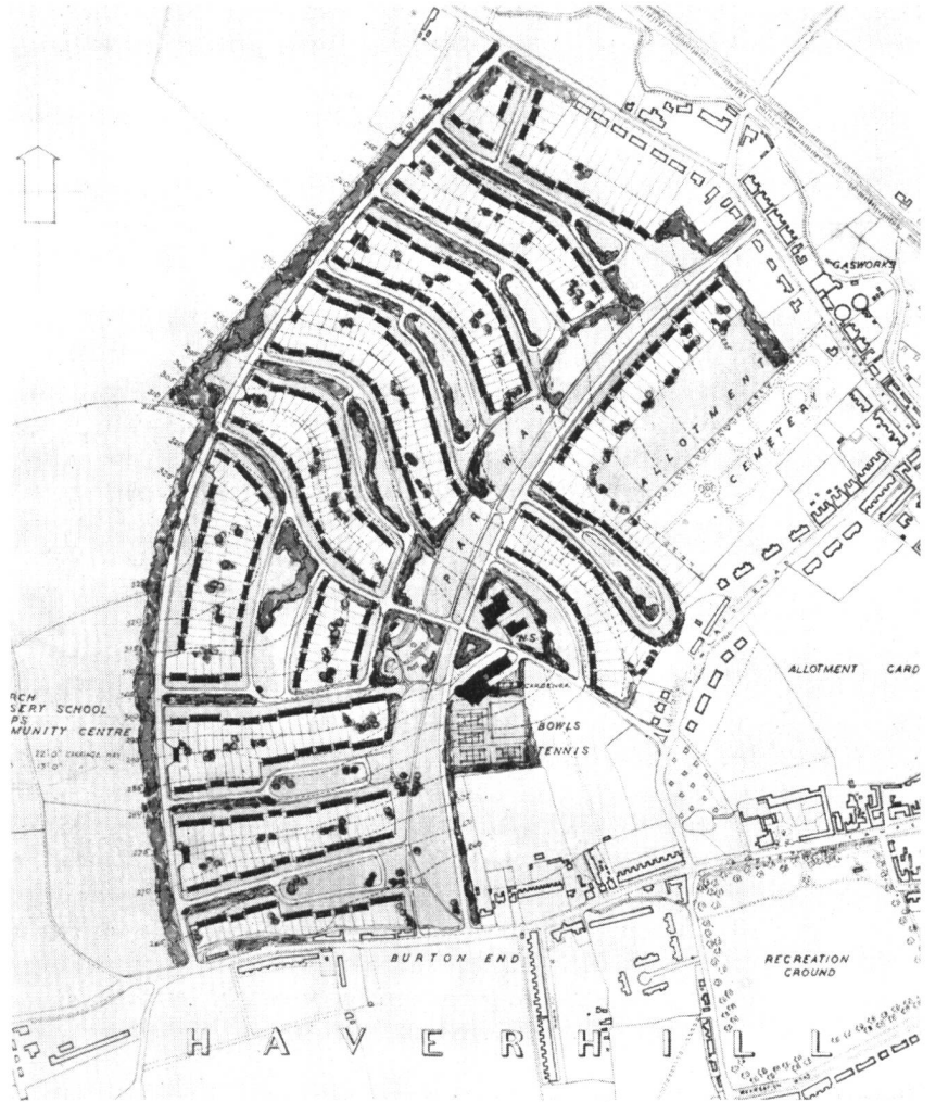
Abb. 2. Beispiel eines englischen Ortserweiterungsplanes. Die Erschliessungsstrassen liegen in Parkstreifen mit Baumpflanzungen; so wird das Wohngebiet in einzelne Streifen getrennt. Das Land wird einheitlich erworben und die Kosten der Parkstreifen auf die Bauparzellen verteilt.
