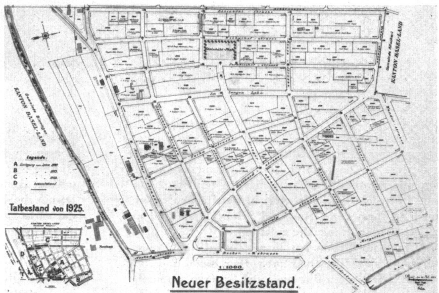
Abb. 9. Baulandumlegung des Gebietes «Im Langen Lohn» in Basel. Darstellung des etappenweisen Umlageverfahrens in den Jahren 1913 bis 1925.
