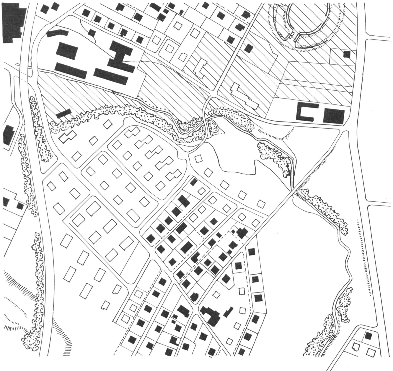
Abb. 9. Ausschnitt aus dem Idealplan über die untern Rüteneu. Hier konnte die neue Ueberbauung praktisch nach diesem Plan gestaltet werden. Das in der Grünzone (im Plan schraffiert) nördlich des Süssbaches vorgesehene neue Schulhaus ist dagegen in das Quartier Dohlenzelg verlegt worden.
