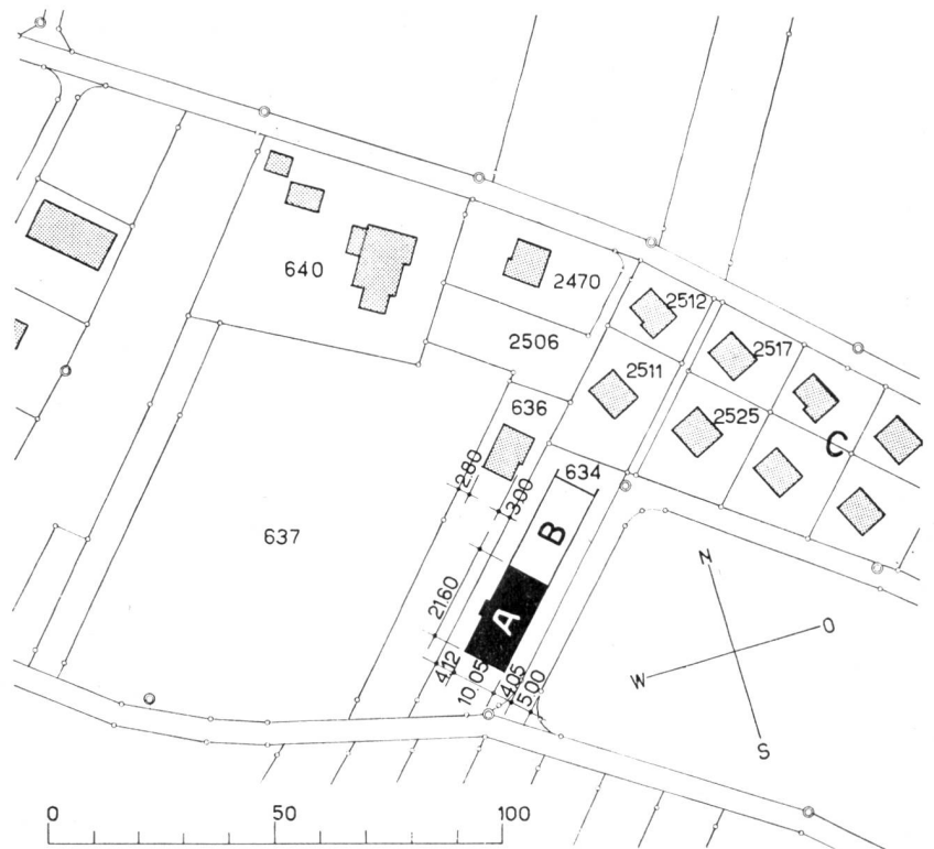
Abb. 1. Situationsplan 1:1000. Das Hochhaus A mit einer Grundfläche von rd. 10×21 m und den angebauten Garagen B steht auf einer Terrasse südwestlich der anderthalbgeschossigen Einfamilienhäuser C, die vom gleichen Architekten projektiert wurden. Das Hochhaus weist vom nichtausgebauten Zugangsweg mit 5 m Breite einen Abstand von 4,05 m auf. Der Grenzabstand zur nachbarlichen Liegenschaft beträgt 4,12 m. Weder in bezug auf die Eingliederung ins Ortsbild noch in bezug auf die Erschliessung noch auf die Auswirkung auf die unmittelbare Nachbarschaft ist das Projekt studiert. Neben den vollkommen fehlenden Parkierungsmöglichkeiten wurden weder für die Sicherheit der Passanten (Stabgeländer der Balkone gegen die Strasse) noch für die Sicherheit der Bewohner genügende Massnahmen getroffen.
