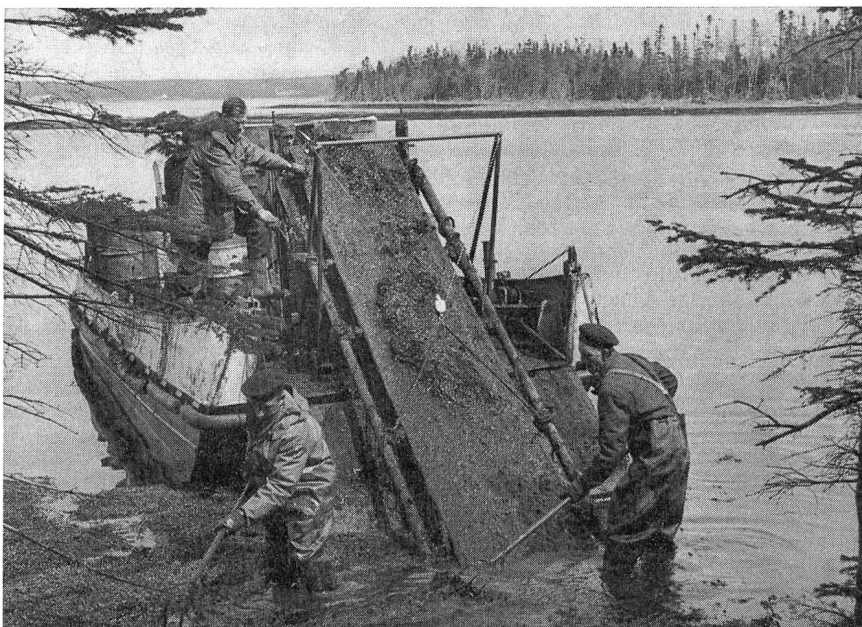
Fig. 3. On s'est servi de «slick-lickers», ou bandes transporteuses couvertes d'une toile de coton bouclé pour absorber le mazout répandu à la surface des eaux (Photos: Ministère des transports)
