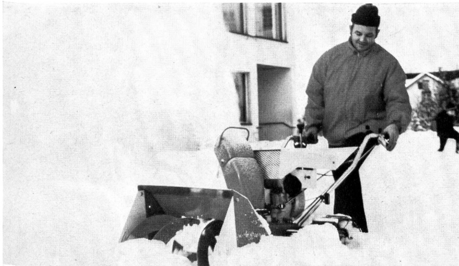
Abb. 3. Die Unitrac-Combi-Schneesleuder lässt sich ohne Werkzeuge minütenschnell in einen Sichelmäher, Salz- und Düngerstreuer, Abfall- und Laubsauger sowie in einen Grossflächenwischer umstellen ▼
