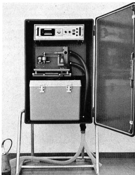
Abb.1 Mobile Probenahmestation Steuergerät, Probenahmeeinheit, Tauchpumpe
