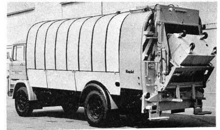
Abb. 1. Kuka-Müllwagen sind in jedem Falle mit einer Container-Schüttung versehen. Dank dem steilen Einkippwinkel können die Behälter mühelos entleert werden
