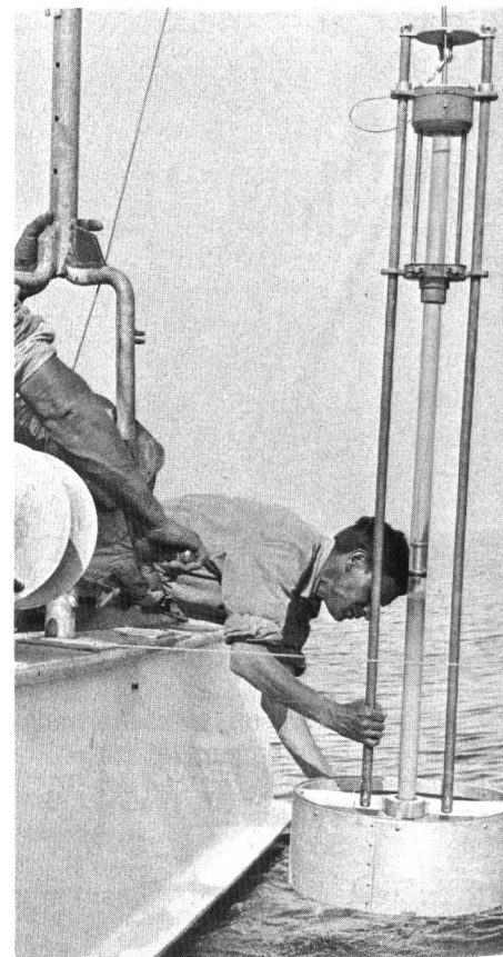
Abb. 17. Raumkolbenlot, System Züllig , zur Entnahme nicht zusammengestauchter Bohrkern bis mehrere Meter Länge.
