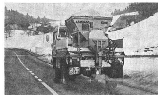
Aufsatzstreuer Ammann 1000 für Kommunalfahrzeuge, Behälterinhalt 1 m 3 .
