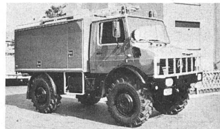
Unimog U 1700 (168 PS), ausgerüstet als Schlauchwagen für die Flugplatzfeuerwehr Kloten
