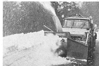
Unimog U 1000 (95 PS) mit Seitenschneefräse und Aufsatzstreuer
