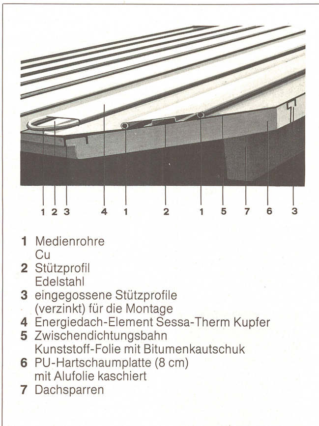
Abb. 2. Aufbau des Energiedaches.
