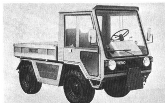
Kleinfahrzeug Tremo 3,5 junior. Breite 1,3 m, Nutzlast etwa 2 t.
