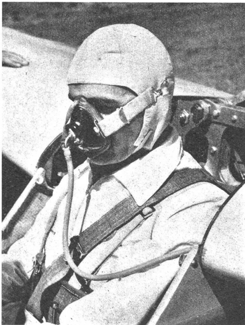
Bild 4: Sauerstoff-Atmungsgerät. Gedenkt ein Segelflieger sich höher als vier- bis fünftausend Meter hinauftragen zu lassen, dann startet er mit einem Segelflugzeug, das mit einem Sauerstoff-Höhenatmungsgerät ausgestattet ist.
