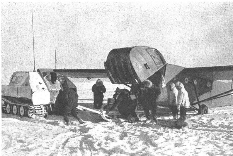
Für den Nachschub wurden auch Segelflugzeuge im Schlepp eingesetzt. Wir sehen auf dem Bilde ein Segelflugzeug, das die Expedition unterwegs erreicht hat. Soeben wird ein kompletter Motor ausgeladen, der einen unbrauchbar gewordenen in einem Schneeamobil ersetzen soll.
