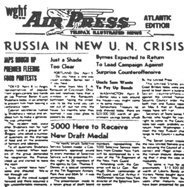
Bild 5: Die «Zeitung aus der Luft», wie sie vom Sender WGHF in New York regelmäßig ausgestrahlt wird und mit Hilfe von Facsimile-Empfangsgeräten in jedem Hause der Großstadt und Umgebung empfangen werden kann. Auch Halbtönebilder, wie Photographien, werden in der Qualität von Zeitungsreproduktionen wiedergegeben.
