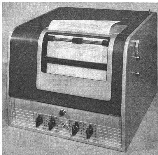
Bild 3: Vollautomatisches Send- und Empfangsgerät. Bei der Sendung wird das Dokument in den an der Vorderfront unten erkennbaren Schlitz gesteckt und durch Druck auf einen Knopf der Apparat in Betrieb gesetzt. Der Empfang erfolgt vollautomatisch: die Schreibvorrichtung wird durch ein Signal vom Sender ausgelöst. Auf dem Bild ist der Empfang eines facsimilierten Briefes zu sehen. (System Finch)
