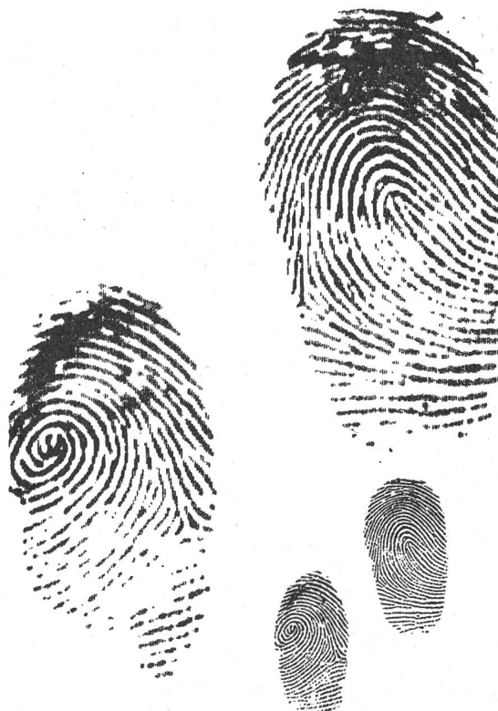
Bild 4: Facsimile von Fingerabdrücken. Der Empfang erfolgt in vergrößertem Maßstab, damit die polizeiliche Auswertung sofort vorgenommen werden kann. Rechts unten die Original-Fingerabdrücke, die für die Sendung benützt wurden.
