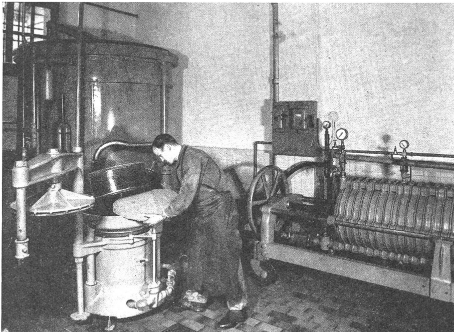
Bild 4: Rechts im Bilde eine moderne Filterpresse. Jede einzelne der auswechselbaren Kammern enthält einen Filter«kuchen», wie er eben der «Kuchen»presse entnommen wird. Das filtrierende Material ist zum Beispiel Zellulose und wird nach jedem Arbeitsgang in der zylindrischen Filterreinigungsmaschine links gründlich gewaschen und desinfiziert. Bild aus der Obstverwertungsgenossenschaft OVA, Affoltern am Albis Photo Klauser, Zürich
