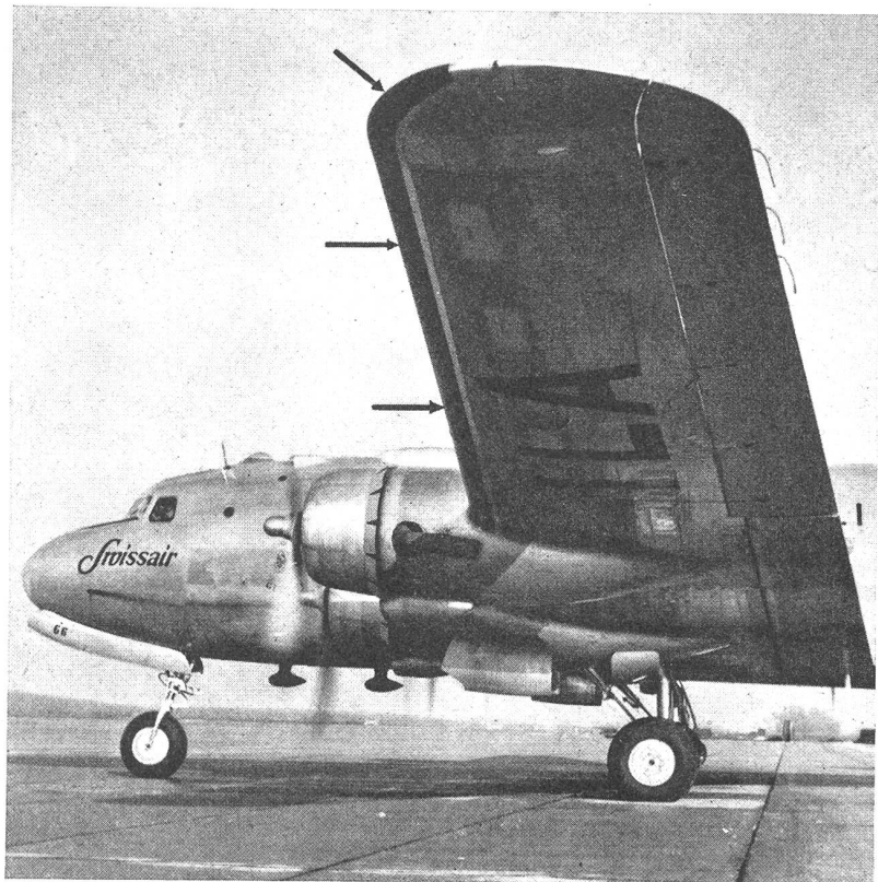
Bild 8 (unten): Durch das mehrmalige wechselweise Aufpumpen und Entleeren dreifach angeordneter Gummischläuche ist in einem Segment das Eis bereits abgesprengt worden.
