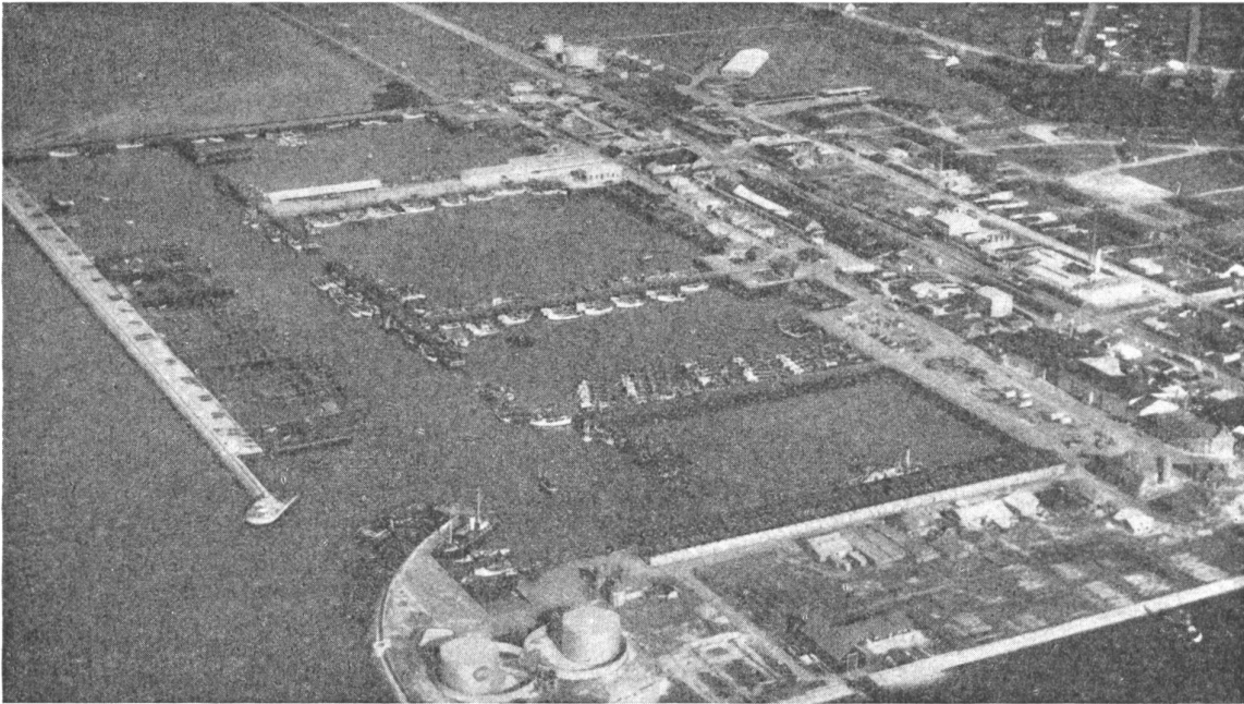
Bild 1: Fliegeraufnahme des Fischerhafens von Esbjerg. Im Vordergrund die lange Auktionshalle, dahinter die vier Hafenbecken. Die meisten Schiffe sind auf dem Meer. Längs des Hafens die Filets- und Konservfabriken, Eis- und Petroleumwerke. Links die Einfahrt und der «Wellenbrecher».
