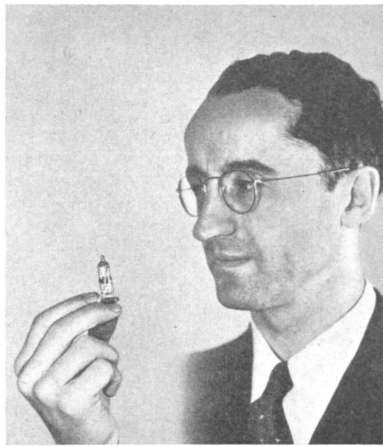
Bild 2: Dr. C. Brunetti vom U. S. Bureau of Standards hat diesen Einröhren-Mikrowellensender in Lippenstift-Format hergestellt, um mit den Angestellten seines Amtes auf größere Entfernung sprechen zu können. Die Schaltelemente sind auf der winzigen Senderöhre mit elektrisch-leitender Farbe aufgespritzt.
