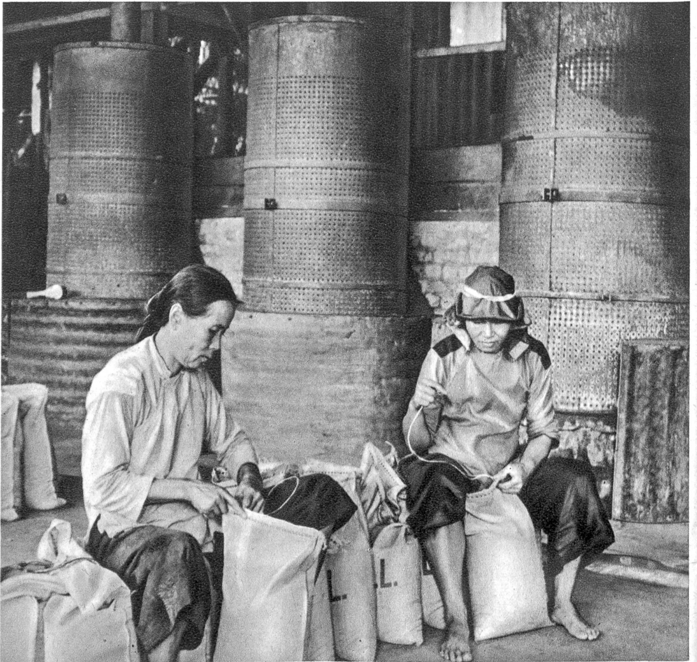
Nachdem das ausgewaschene Zinnerz in den im Hintergrunde sichtbaren Öfen getrocknet ist, wird es in Säcke gefüllt, die dann zugenäht werden
