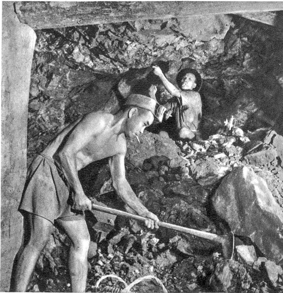
Das losgesprengte Erz wird von chinesischen Arbeitern gesammelt und zutage gefördert
