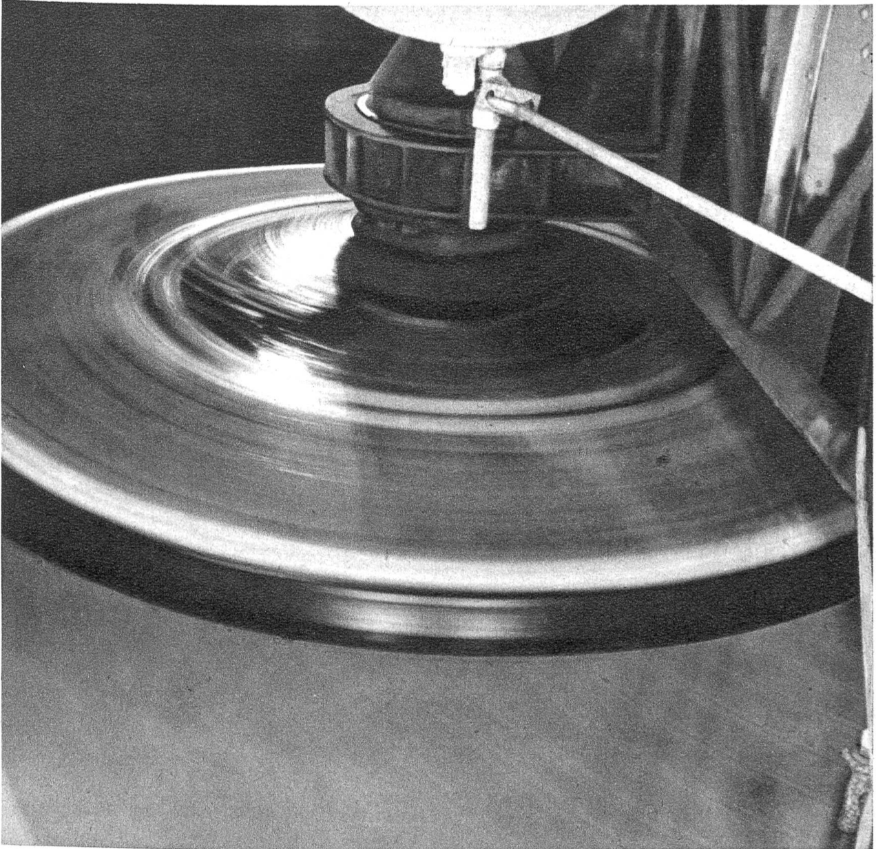
Abb. 1: Ein Ausschnitt aus dem riesigen Karussell der Schleifmaschine. Die Schleifscheibe mit ihren scharfkantigen Stahlrippen hat sich auf die Glasplatte gesenkt
