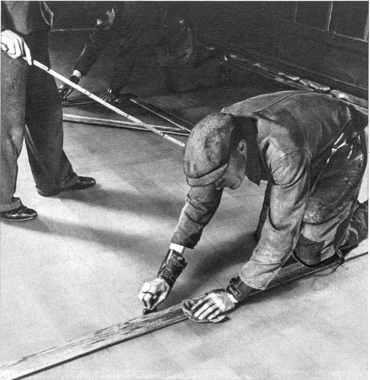
Abb. 4: Gehärtete Stablrädchen werden an Linealen entlanggeführt und schneiden aus der großen Glastafel die gewünschten Stückgrößen heraus
