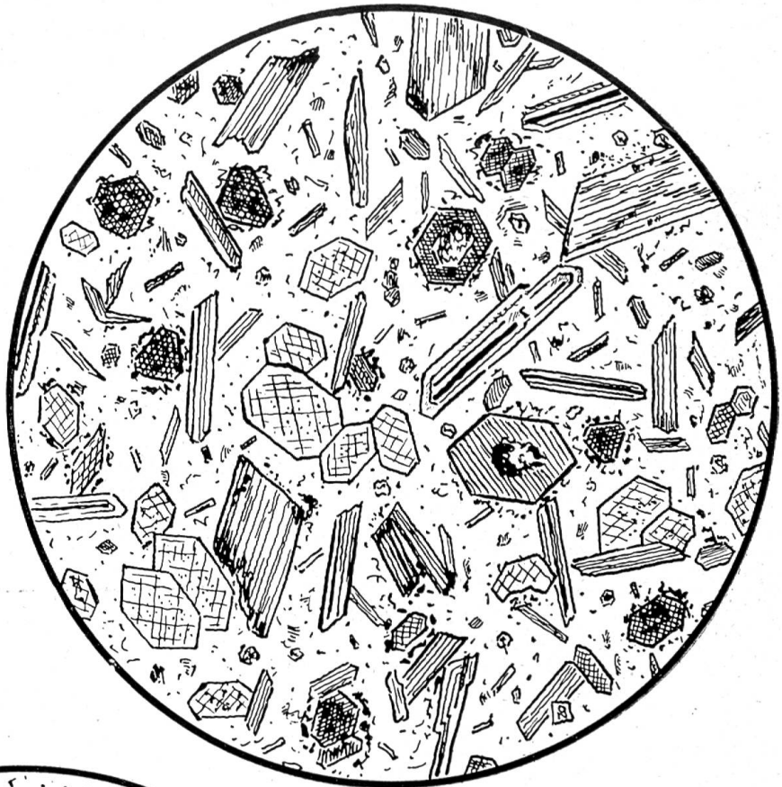
Abb. 15: Eigengestaltige – idiomorphe – Ausbildung verschiedener Mineralien in einem basalt-ähnlichen Ganggestein (Mondiquit) mit glasiger Grundmasse; Systeme von Spaltrissen und typische Kristallumrisse erkennbar
