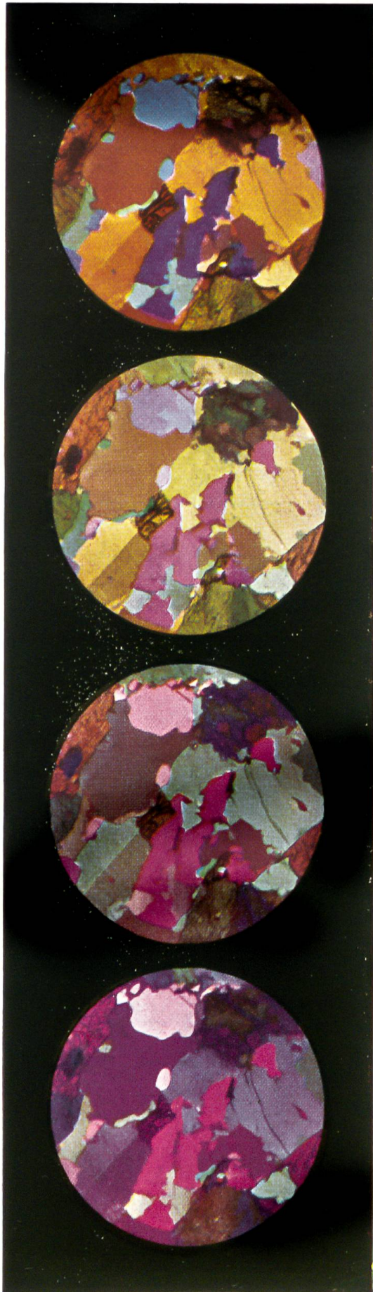
Abb. 5 bis 8: Hornblendezirconit aus der Gegend von Dresden. Von oben nach unten mit Kompensator Rot I. bis IV. Ordnung
