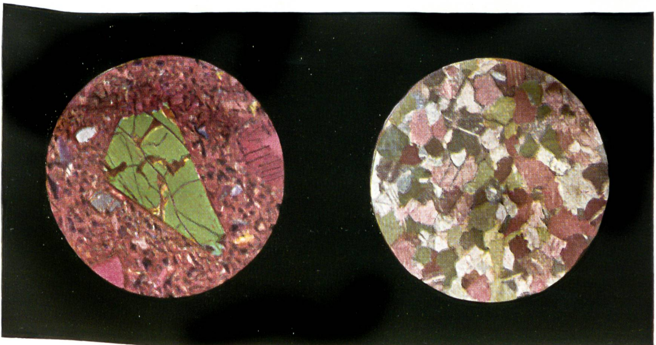
Abb. 11: Nephelinitbasalt aus Sachsen, ein typisches Ergußgestein
