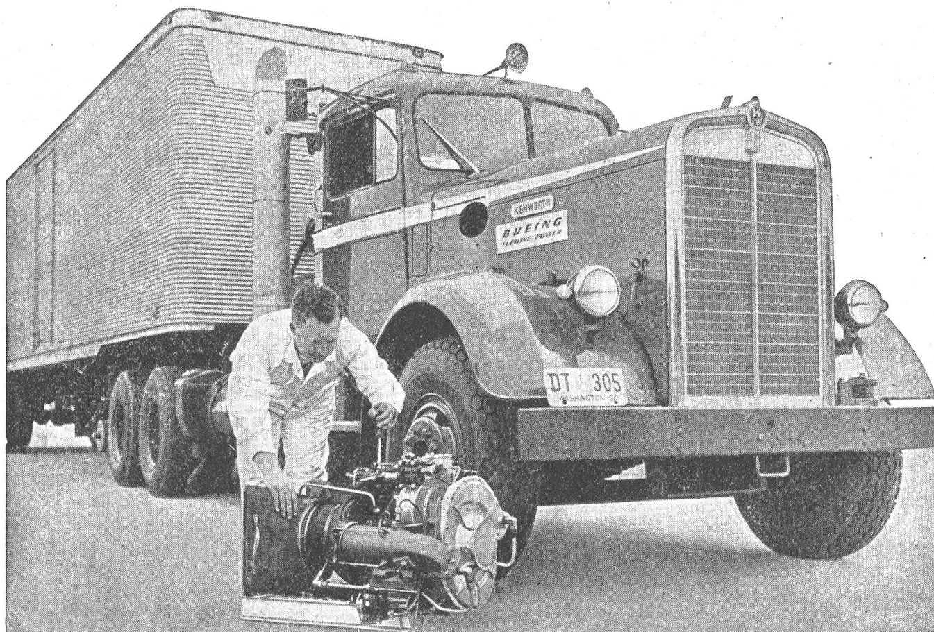
Diesen 30-Tonnen-Riesen bezwingt der Turbinen-Zwerg „Boeing 502“! Die Diesellastzug-Fahrer, die er auf den Landstraßen überholte, kamen aus dem Staunen nicht heraus. Die Motorhaube, die noch auf einen der üblichen Dieselmotoren zugeschnitten ist, hat in diesem Falle freilich ihre Daseinsberechtigung verloren
