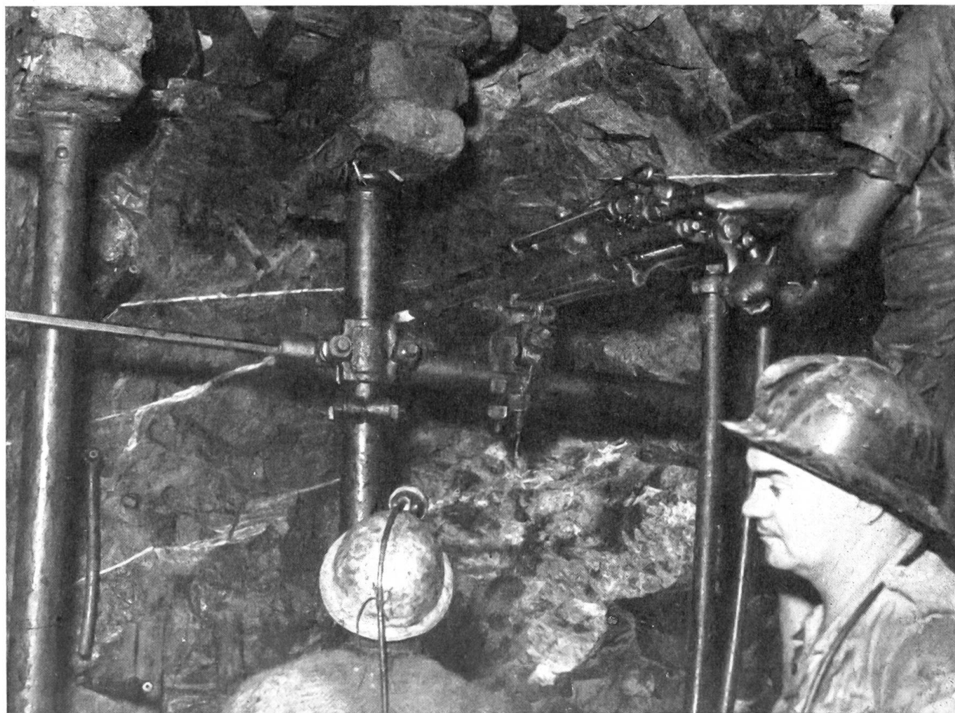
In Witwatersrand in Südafrika ist die größte Goldindustrie der Welt entstanden. Die Goldminen liegen hier sehr tief, zum Teil bis zu 3000 m unter der Erdoberfläche. Das Bild zeigt Minenarbeiter einer Goldgrube beim Ausbohren von Sprenglöchern
