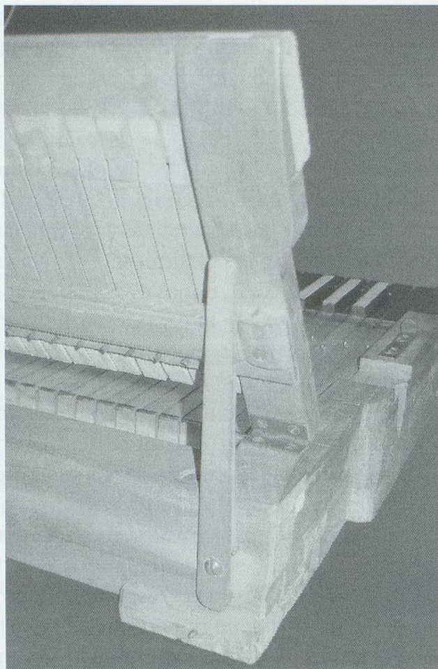
Photo 4 : Clavier du pianoforte de Pascal Taskin, Paris, 1788 : pilotes de touches et clapettes. Coll. Musée de la musique, Paris, inv. D.OA.10298. Photo Jean-Claude Battault, © Cité de la musique, Paris
