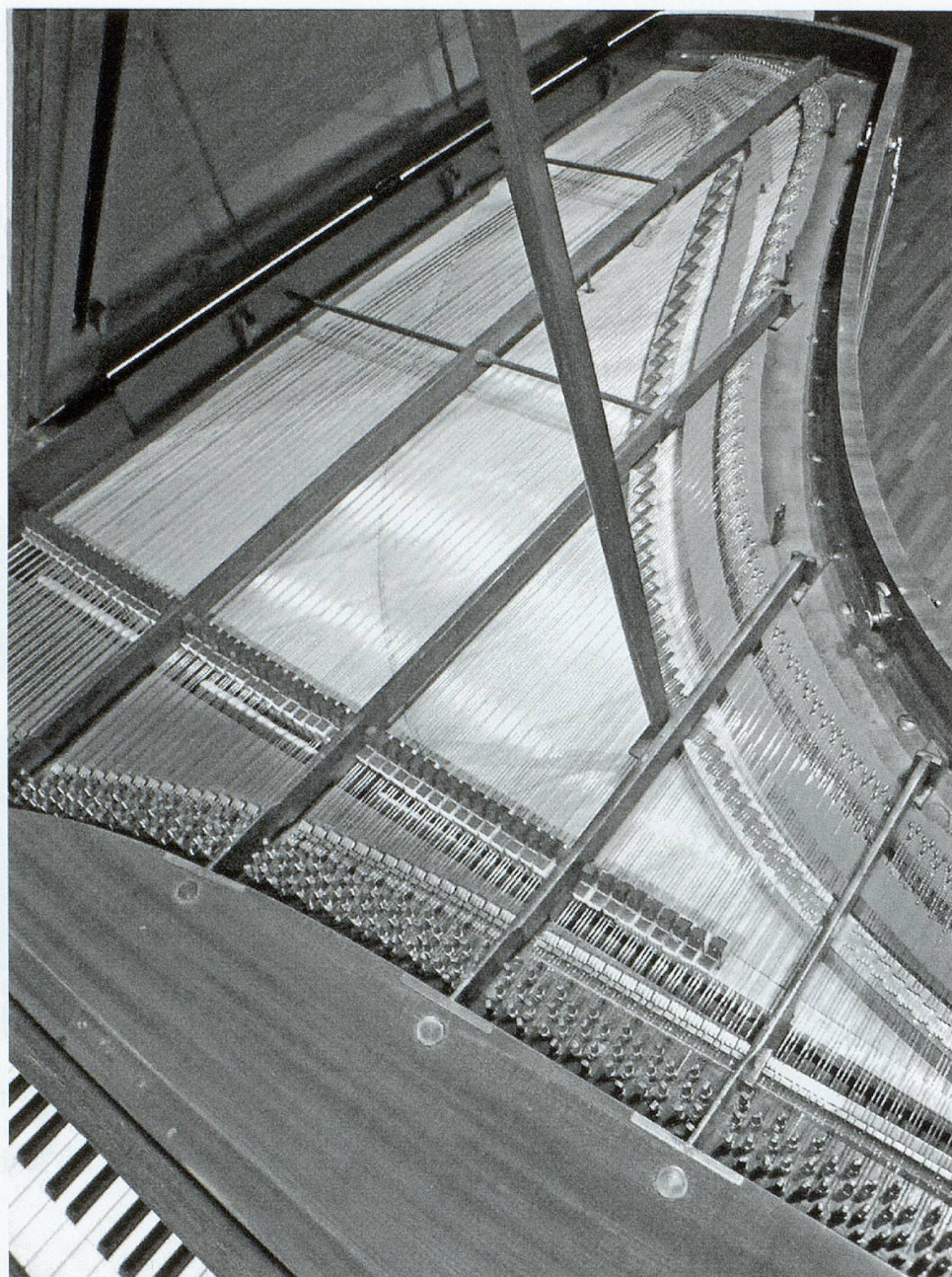
Illustration Kat. 37. Barrage métallique, pianoforte Ignace Pleyel & C ie , N° 9166, Paris 1840
