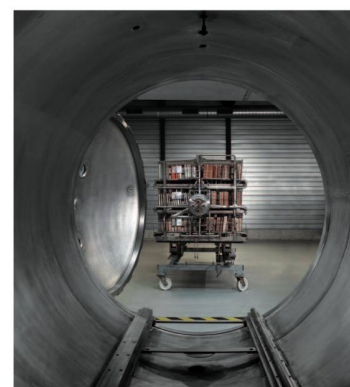
L'installation papersave swiss à Wimmis. Une « charge » de documents attend d'être désacidifiée.
