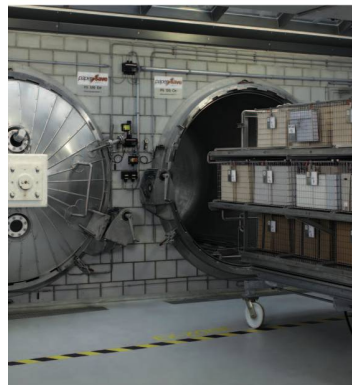
L'installation papersave swiss à Wimmis. Une « charge » de documents est introduite dans la chambre de traitement.
