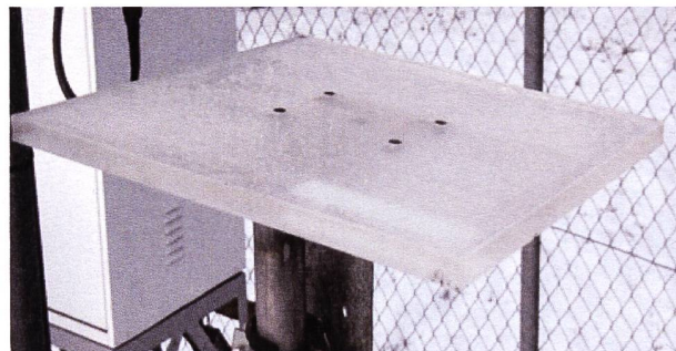
Figur 1: Staubfangplatte am Zaun des ZWILAG-Areals.
