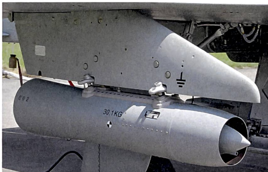
Figur 2: Höhenluftfilter-Aggregate: Detail-Aufnahme eines Sammelgerätes.
