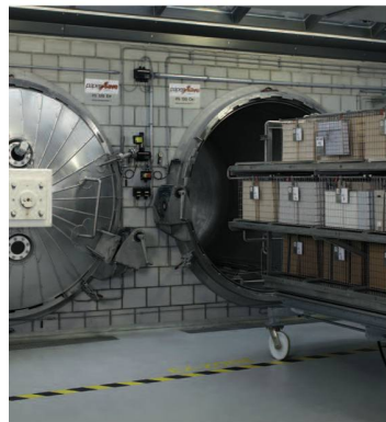
Impianto Papersave swiss, Wimmis. Un carico viene immesso nella camera.
