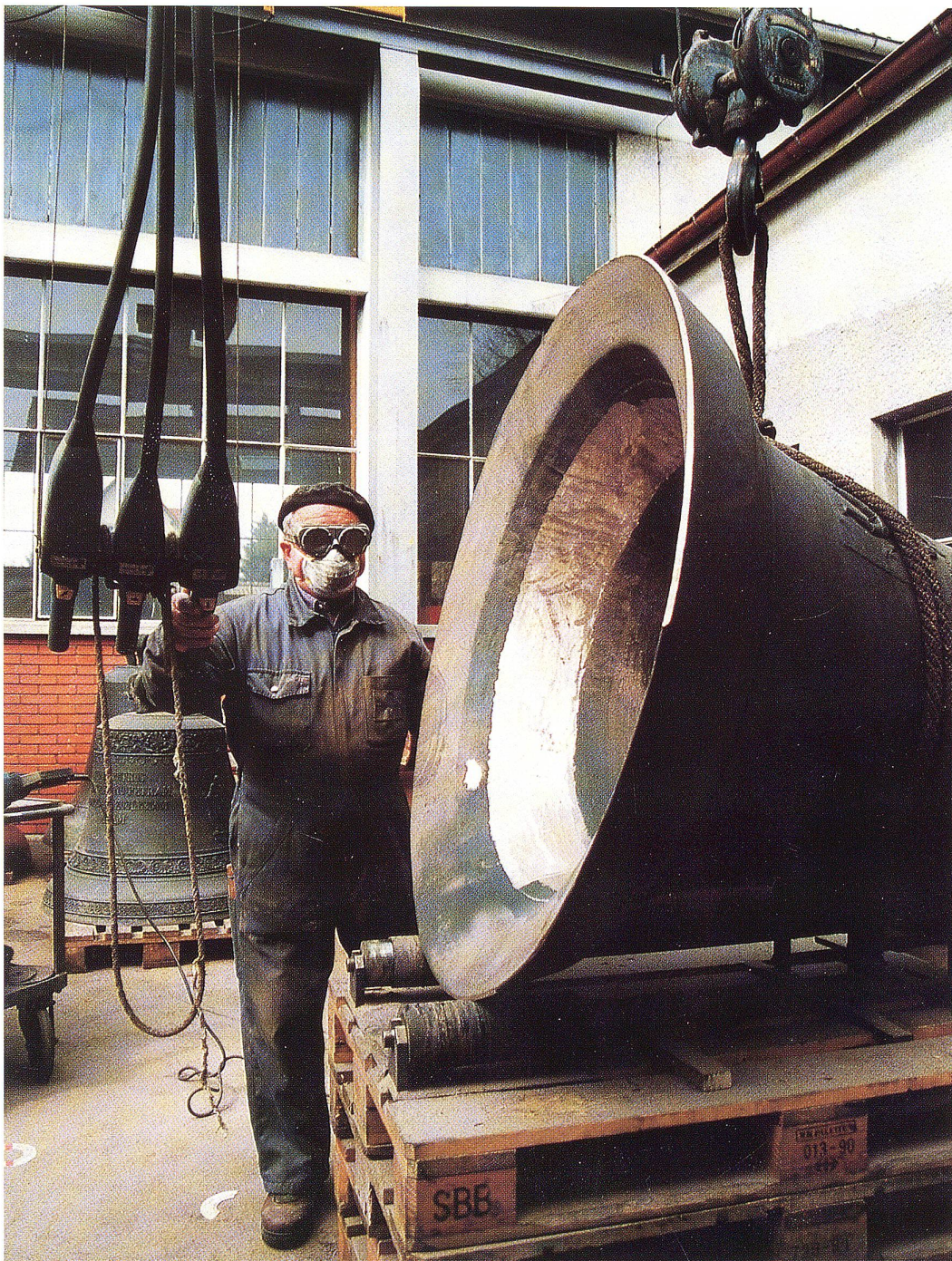
Immer wieder muss mit Hilfe des Kranens die Position der Glocke verändert werden, damit der Schliff auf allen Seiten vorgenommen werden kann.
