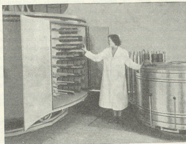
Centrifuge à broches pour bobines et le sécheur approprié (Hans Franchiger, Zofingue A. G., Suisse.)
