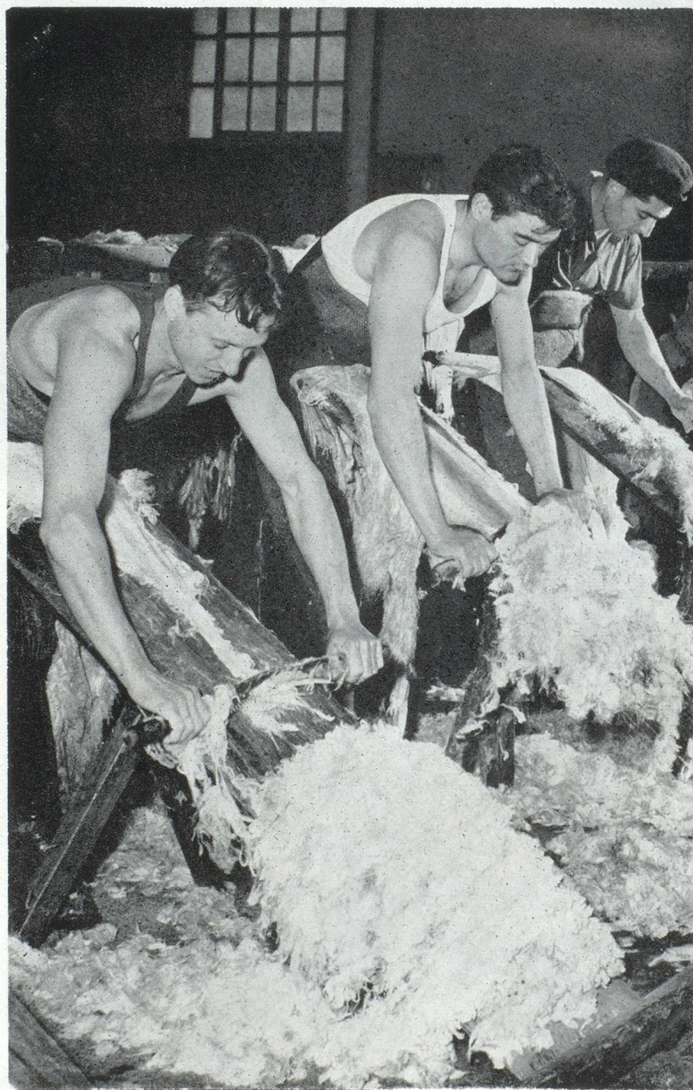
L'opération du pelage des peaux
