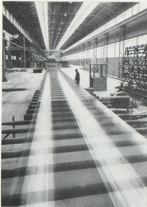
Le ruban continu de verre, tel qu'il sort du tunnel de l'étenderie pour se refroidir jusqu'à la température ambiante et être attaqué par les appareils du Twin douci.
