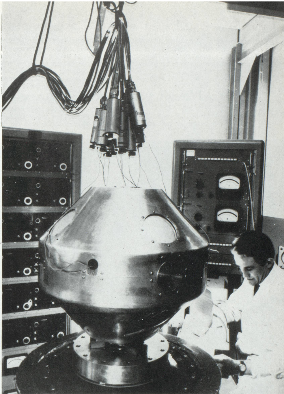
Le premier satellite technologique, qui sera lancé par la Délégation Ministérielle pour l'Armement pour la mise au point du lance-satellite Diamant. Vue du satellite en essai sur table vibrante à la Société M.A.T.R.A.
