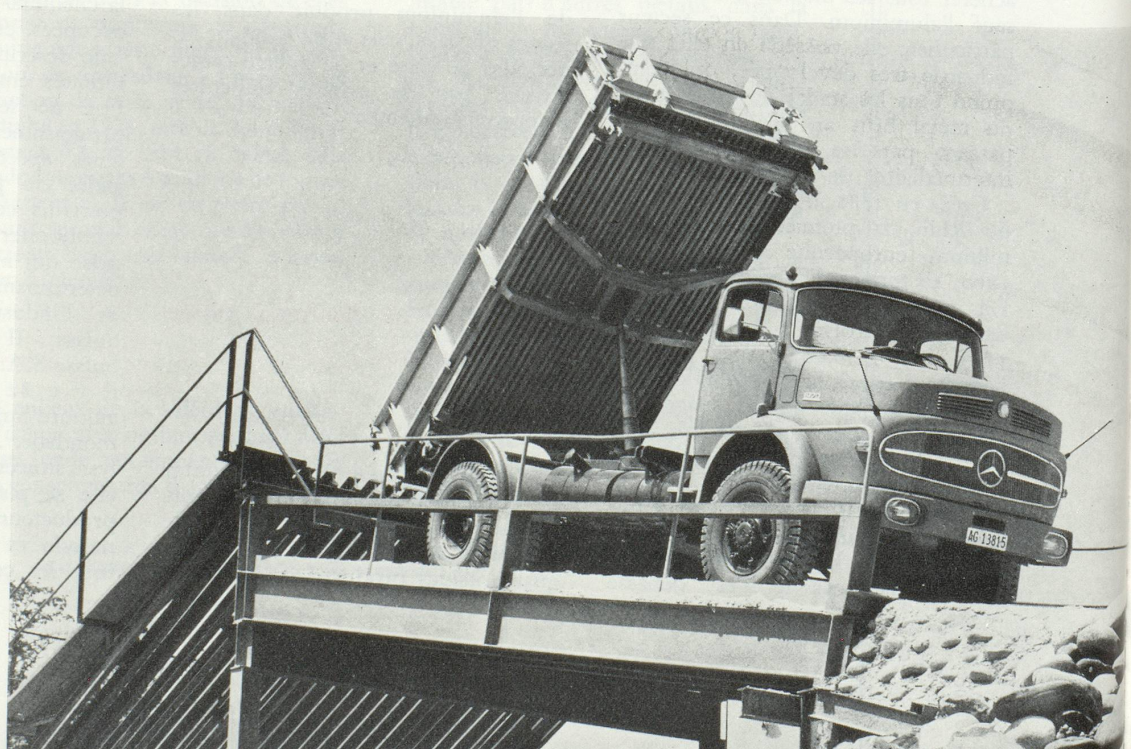
Camion avec plateau basculant tout aluminium.
